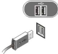
Kuva 6. Näppäimistö- ja hiiriliitäntä
